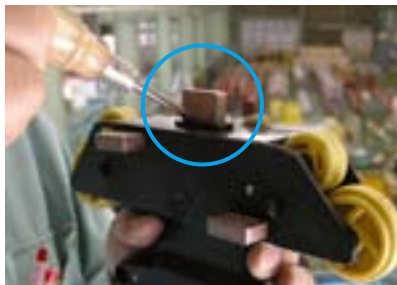
集電ブラシの取り外しは、○ドライバーを差し込んで持ち上げるだけ。
