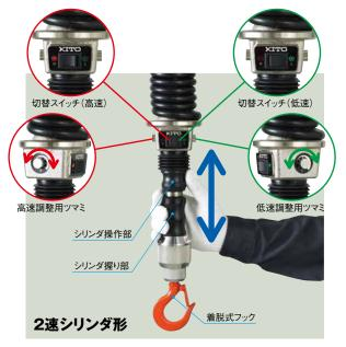
握り部を握りながら親指で操作部を上下にスライドすると作動します。 ワンタッチで高速・低速の切替が可能で 左右それぞれの調整用ツマミで最適な速度調整ができます。
