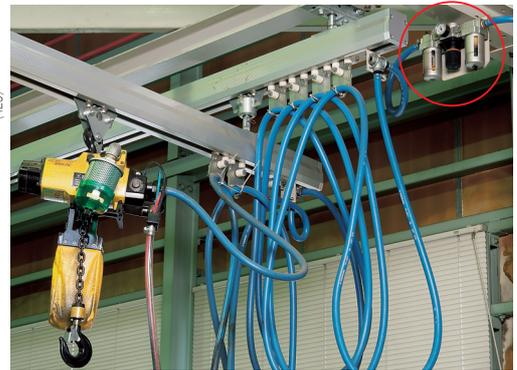
※エアホストには潤滑油が必要な為、エアフィルタ、レギュレータおよびルブリケータは、できるだけエアホストの近くの配管に接続してください。
