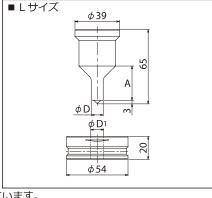
$\times$  S サイズ刃物  $\phi$  18 (RPF-18S) も在庫しています。 ※ L サイズ刃物  $\phi$  18 (RPF-18L) ·  $\phi$  22 (RPF-22L) ·  $\phi$  25 (RPF-25L) も在庫しています。 ※ 刃物はポンチ・ダイスのセット販売のみです。 ※ 特殊刃物の製作も可能です。注文時に $\phi$  D をご指示ください。(受注生産)
